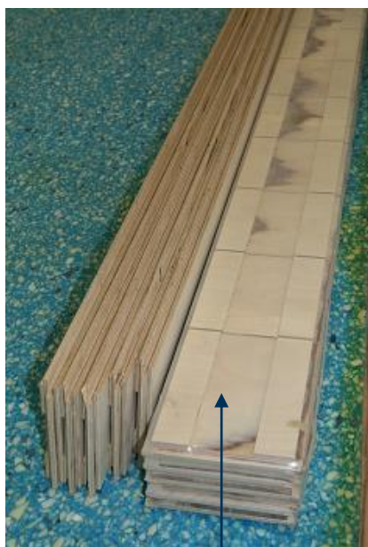
Parte posterior del panel Lumaflex: este lado debe descansar sobre la espuma
