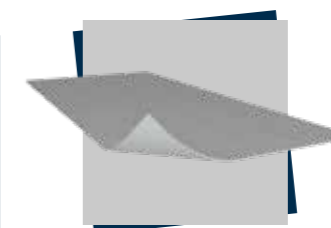
TOUCHDOWN Rouleau de protection en PVC Poids total : 2,2 kg/m 2 Épaisseur totale : 1,45 mm 2 m x 27 ml
