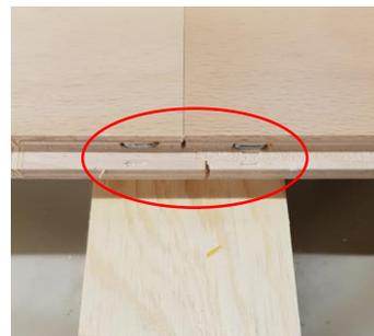
Para colocar las grapas, utilice un compresor y una pistola de aire.
